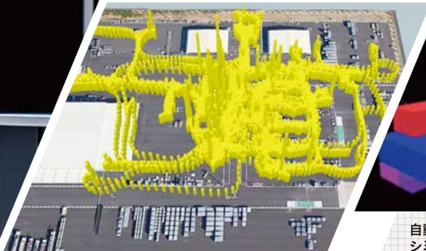
リフトにGPSを搭載。動線をデータ化することで、より効率的なレイアウトを検討し、入出庫にかかる時間のさらなる短縮を実現。
